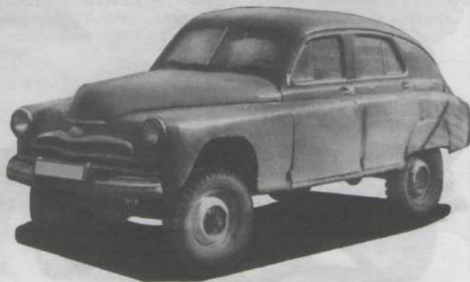
Полноприводной ГАЗ-М72—гибрид армейского джипа ГАЗ-69 и легкового автомобиля «Победа» М-20 (1955 г.)
