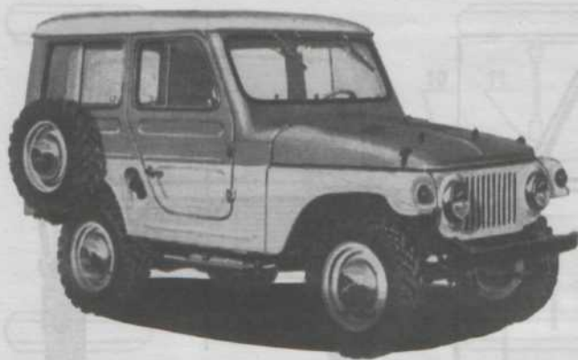
Экспериментальный «Москвич-416» на базе полноприводного автомобиля «Москвич-410Н» (конец 1950-х гг.)
